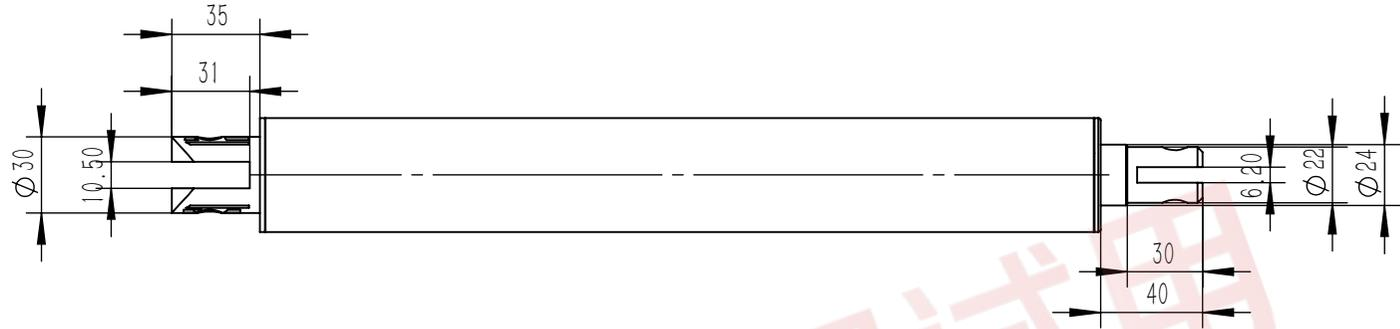
常规安装距: 外管=S+220 内管=S+38 丝杆=S+80
